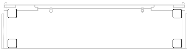
Miejsca klejenia stóp montażowych.
